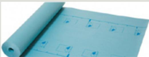
Frein-vapeur armé avec  $\mu$ d variable selon le taux d'humidité. Les lés Pro-Clima DB+ sont renforcés par une armature spéciale, ce qui augmente sa résistance contre le déchirement.
