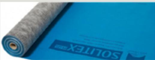
Pare-pluie toiture. Les lés Pro-Clima SOLITEX + pourront être placés entre chevrons, posés sur voliges ou sur un isolant. Sa structure à quatre couches non tissé couvrant en microfibres PP, film TEE, lui confère une résistance incomparable.
