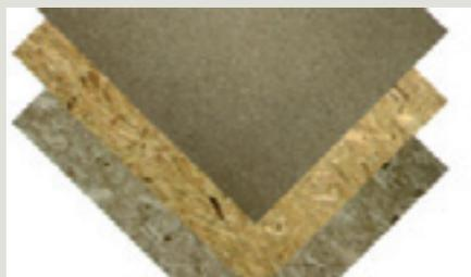
Il est apparenté à l'OSB (Oriented Strand Board) dans son mode de fabrication, les colles utilisées étant totalement différentes. Des petits copeaux de bois résineux sont collés de façon orientés afin d'assurer une très bonne cohésion du panneau.
