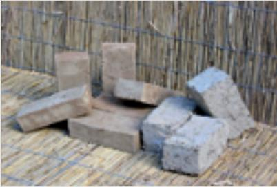
Certaines briques de terre crue, permettent de réaliser des cloisons apportant de la masse thermique et régulant l'humidité. Certaines adobes (07.011) sont particulièrement adaptés au remplissage de structures en bois (avec un enduit extérieur à la chaux).
