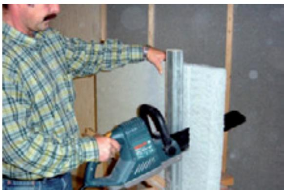
La scie égoïne électrique HOMATHERM® a deux lames de scie oscillantes côte à côte, et est particulièrement adapté à la coupe des surfaces d'isolant.
