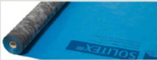
Rouleau pare pluie de sous toiture à base de polypropylène, alliant étanchéité à l'air et capacité de diffusion. Sa forte perméabilité à la vapeur d'eau permet un assèchement rapide des éléments de construction chargés d'humidité pouvant s'échapper par diffusion rapidement et librement.
